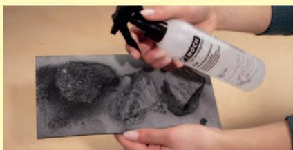
Le moule de rocher est vaporisé d'un agent mouillant se composant d'eau et de liquide vaisselle.
